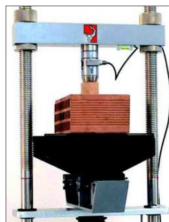
12. Испытание кирпичных блоков на прочность
