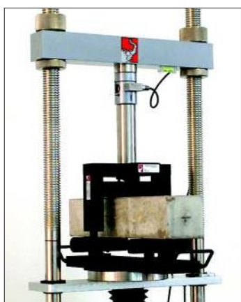
10. Испытания бетонных балок на изгиб
